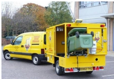
Фото. Обладнання для миття контейнерів на причепах
