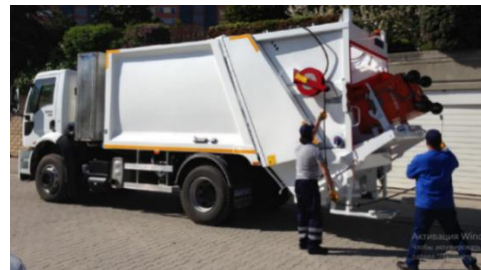
Фото. Смітєвоз HIDRO MAK з функцією миття та дезінфекції контейнерів
