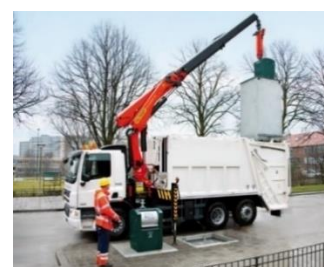
Фото. Завантаження контейнерів підземного розташування
