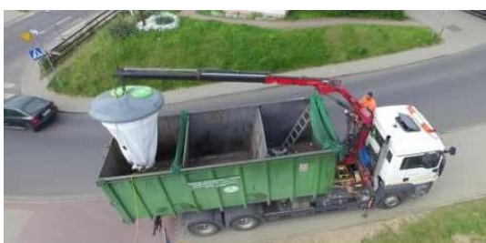
Фото. Завантаження контейнерів підземного розташування
