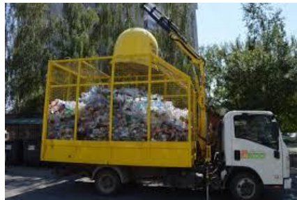
Фото. Контейнери для роздільного збору відходів з нижнім вивантаженням
