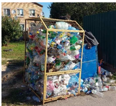
Фото. Контейнер сітчастий металевий місткістю 1,5 м³ для збирання вторинної сировини («Пластик»)
