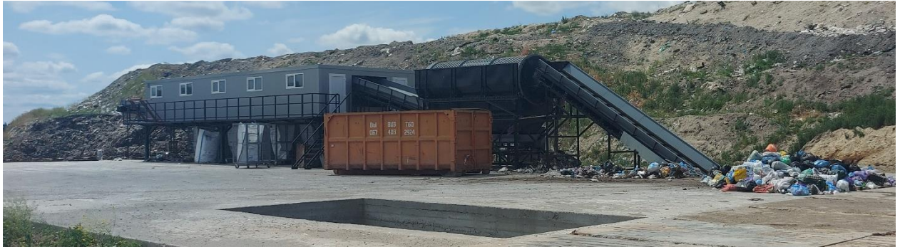
Фото. Сміттесортувальна лінія на полігоні ТПВ в с. Глибоке
